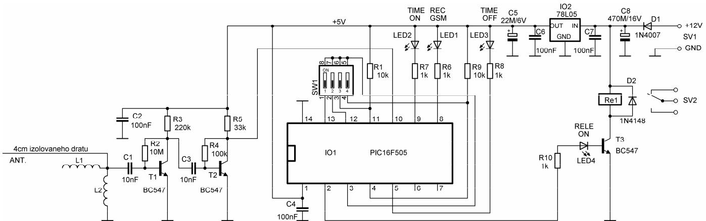
Pozor! Změna! Nyní je ve stavebnici jiný typ procesoru – PIC16F505. Veškerá konstrukce a funkce zůstávají shodné, jen je třeba zapojit 10k odpór z vývodu 11 IO1 na +5V. Doporučujeme provést ze spodní části plošného spoje. Rezistor 10k je součástí stavebnice.
